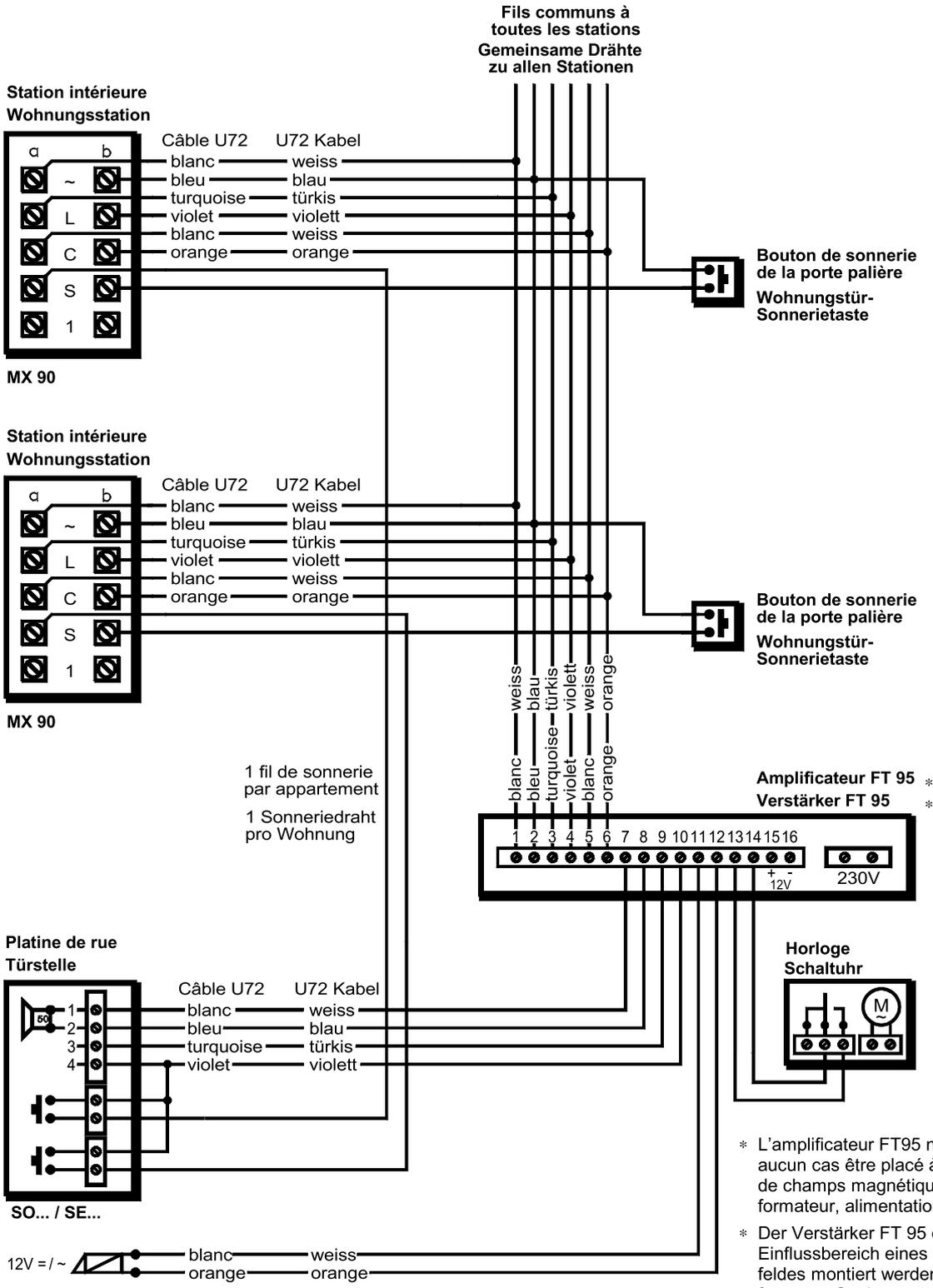
\* L'amplificateur FT95 ne doit en aucun cas être placé à proximité de champs magnétiques (transformateur, alimentation etc.).
